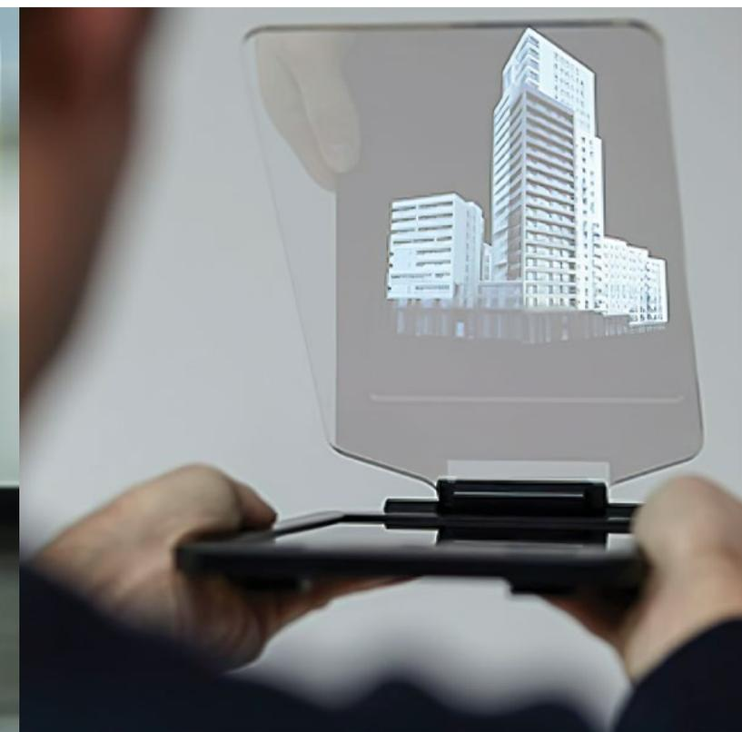
Самый маленький HoloCube - HC Tablet состоит из планшета и прозрачного отражающего экрана со специальным покрытием.
