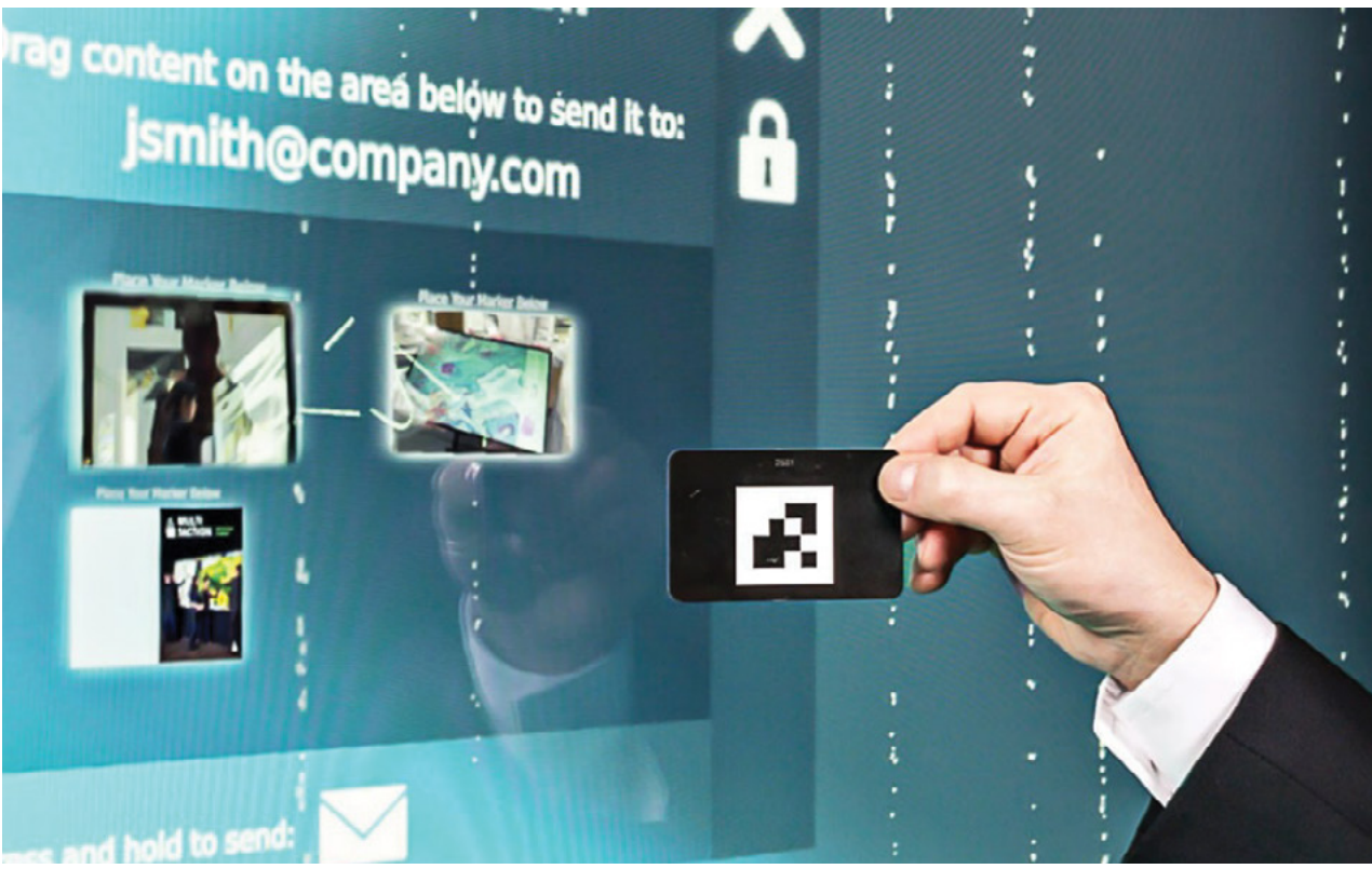
Маркер Codice напоминает QR-код. Для считывания достаточно приложить маркер к экрану MultiTaction. Уникальность маркеров Codice контролирует сервер MultiTouch DRM. Потенциал MultiTouch DRM-сервера – более четырех миллиардов уникальных кодов. Подробнее о технологии – на нашем сайте.
