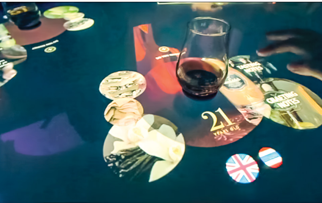
Компания Glenfiddich использовала интерактивный стол MultiTaction с системой Codice для презентации своих напитков. Маркеры Codice прикреплены ко дну бокалов. Когда бокал на столе, появляется информация о его содержимом.
