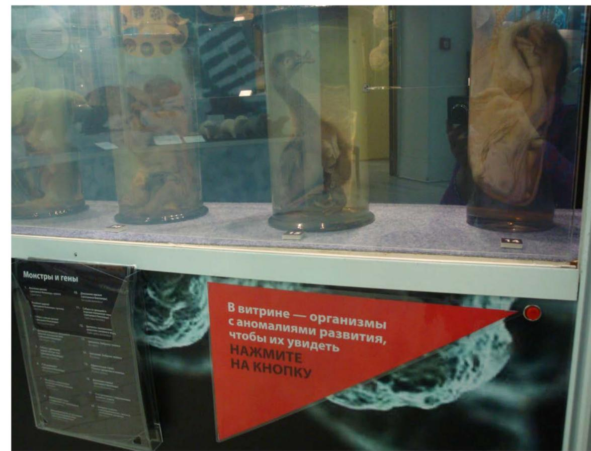
Инсталляция INTMEDIA для выставки “Монстры и гены” в биологическом музее им. Тимирязева: на матовом стекле витрины непрерывно отображается ролик. Проектор не виден - он внутри, за стеклом витрины. Внутри витрины - организмы с аномалиями развития, но чтобы их увидеть, нужно нажать на кнопку. Ролик останавливается, стекло витрины становится прозрачным, автоматически включается подсветка экспонатов.
