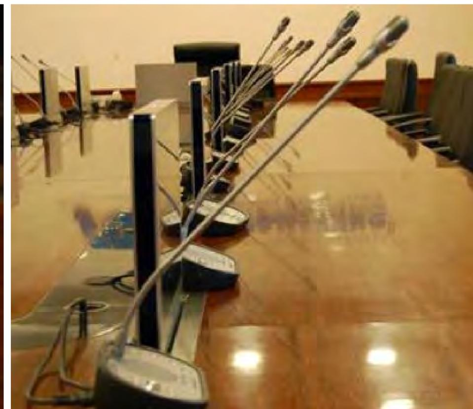
Комплекс оборудования предназначен для проведения не только «внутренних», но и «внешних» совещаний. Ядро комплекса – конференцсистема, дополненная видеоконференцсистемой.
