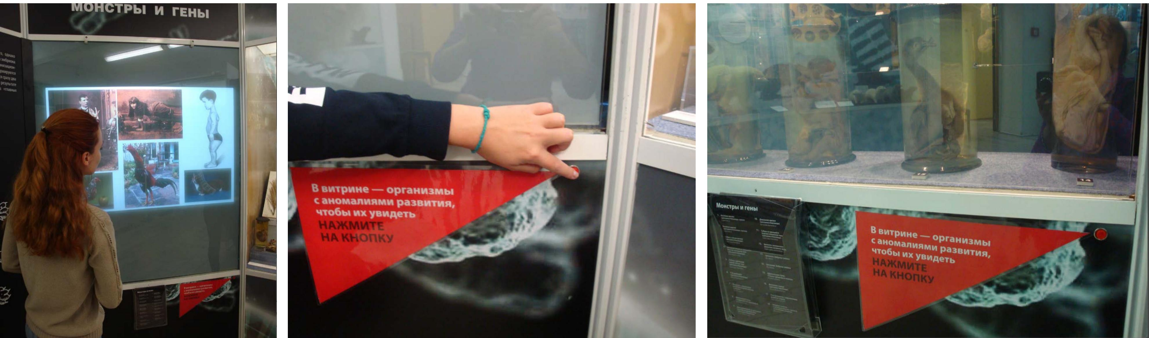
Инсталляция INTMEDIA для выставки "Монстры и гены" в биологическом музее им. Тимирязева: на матовом стекле витрины непрерывно отображается ролик. Проектор не виден - он внутри, за стеклом витрины. Внутри витрины - организмы с аномалиями развития, но чтобы их увидеть, нужно нажать на кнопку. Ролик останавливается, стекло витрины становится прозрачным, автоматически включается подсветка экспонатов.
